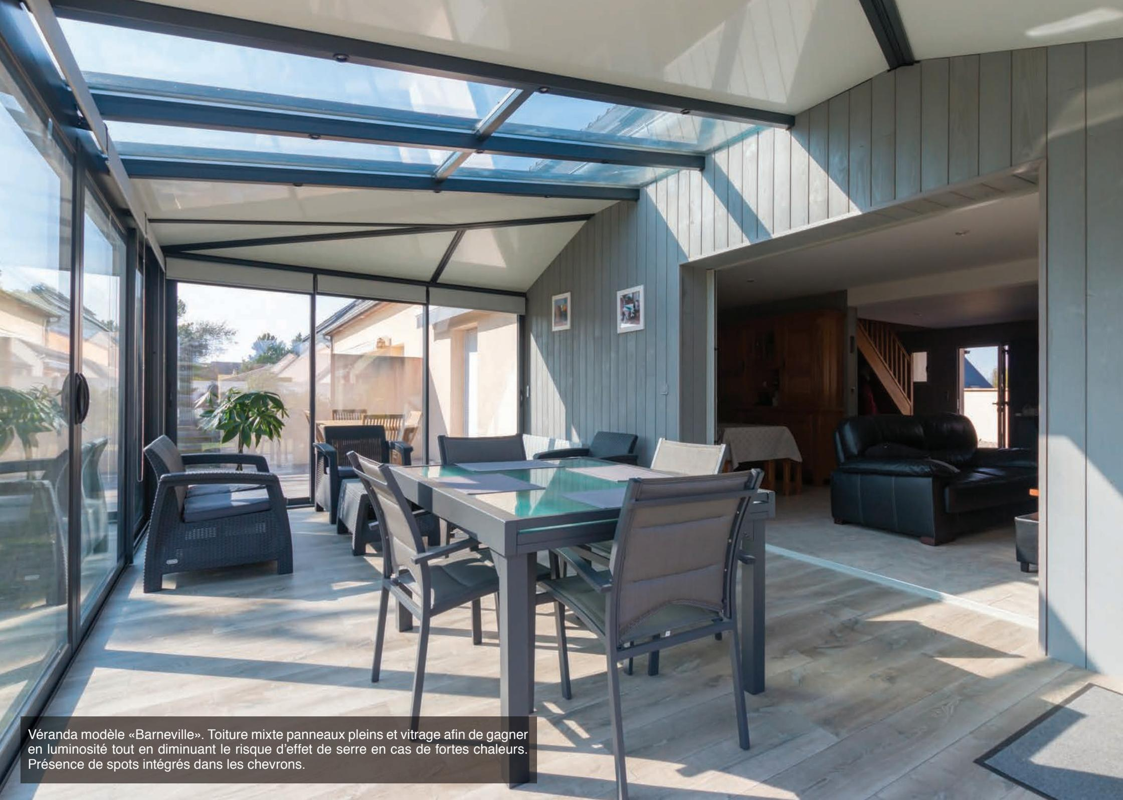
Véranda modèle «Barneville». Toiture mixte panneaux pleins et vitrage afin de gagner en luminosité tout en diminuant le risque d'effet de serre en cas de fortes chaleurs. Présence de spots intégrés dans les chevrons.
