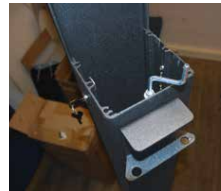
Déverrouillage du moteur Déverrouillage à la clef pour libérer le chapeau
