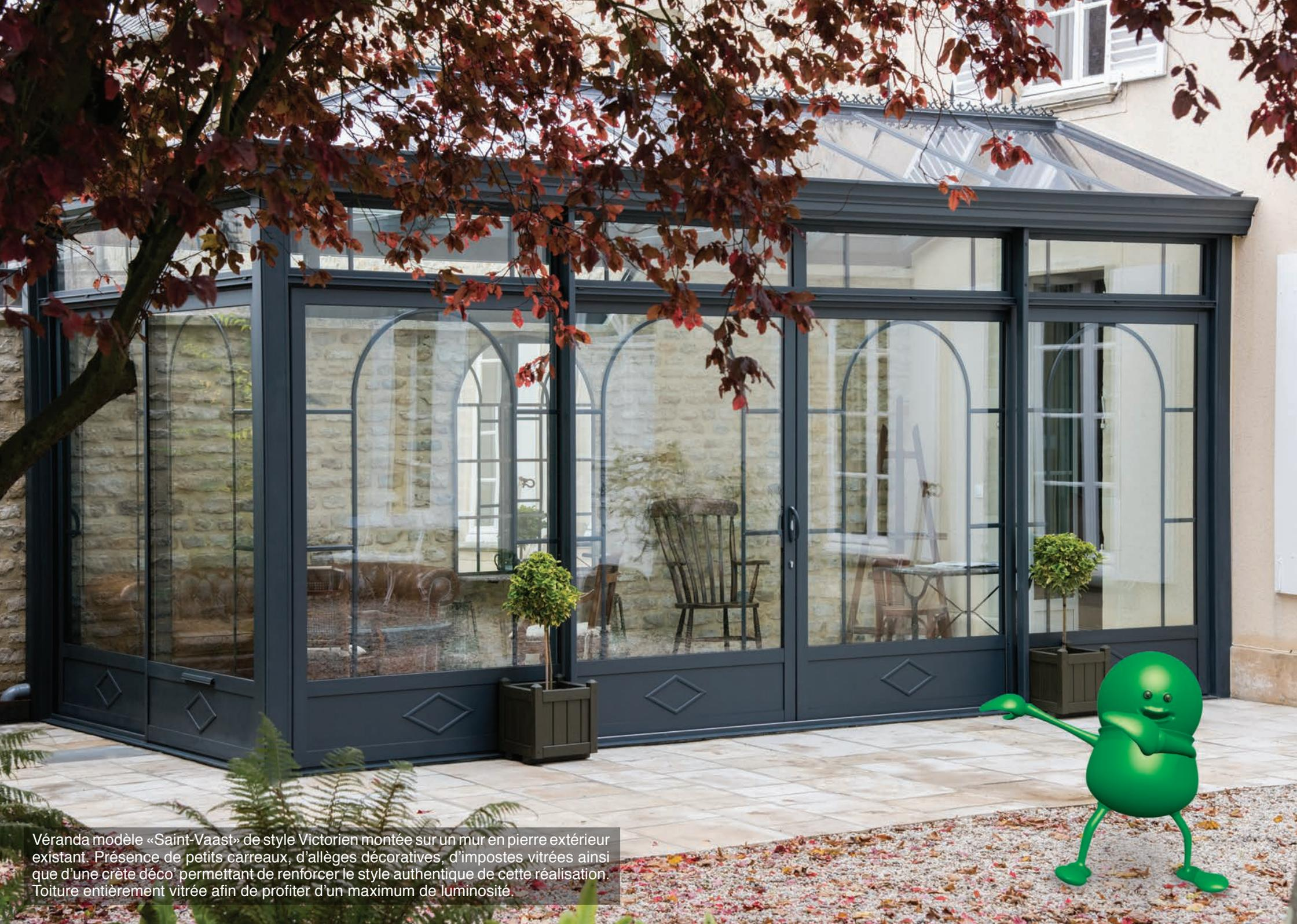
Véranda modèle «Saint-Vaast» de style Victorien montée sur un mur en pierre extérieur existant. Présence de petits carreaux, d'allèges décoratives, d'impostes vitrées ainsi que d'une crête déco permettant de renforcer le style authentique de cette réalisation. Toiture entièrement vitrée afin de profiter d'un maximum de luminosité.
