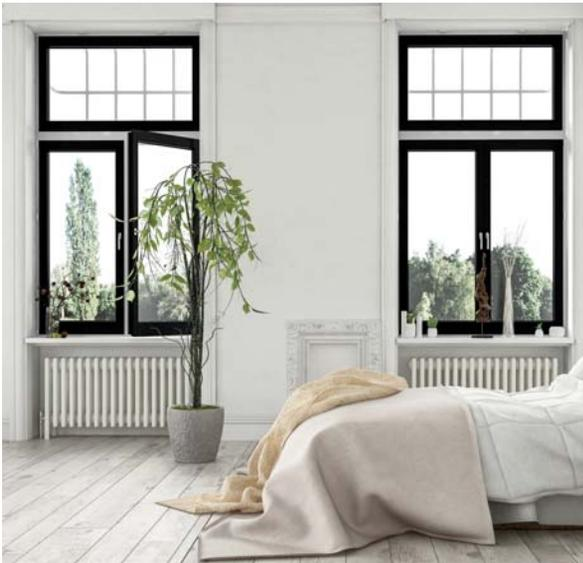
Fenêtres ouvrants à la française, avec châssis fixes séparés
