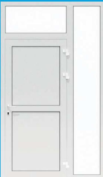
Impostes en position haute ou latérale grâce à un "U" de liaison qui s'adapte entre le bâti de la porte et l'imposte. Ce dernier peut être constitué de remplissages multiples, panneaux lisses ou à rainures ou encore vitrage 44.2 de 24 mm. pour un rendu esthétique, des profils de finition sont aussi en option.
