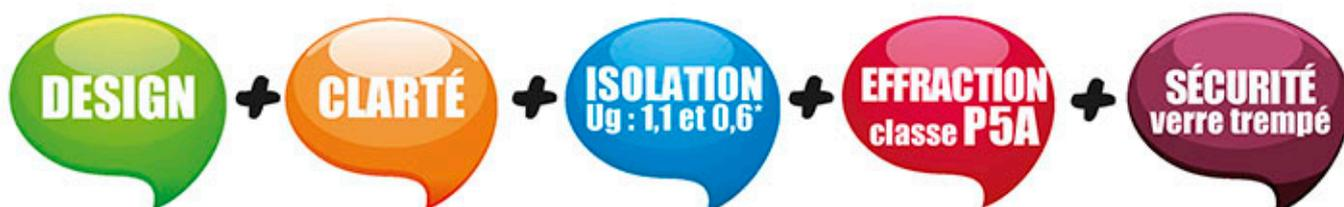
\* 1,1W/(m²·°K) pour du double vitrage épaisseur 28 mm et 0,6 W/(m²·°K) pour du triple vitrage épaisseur 45 mm.
