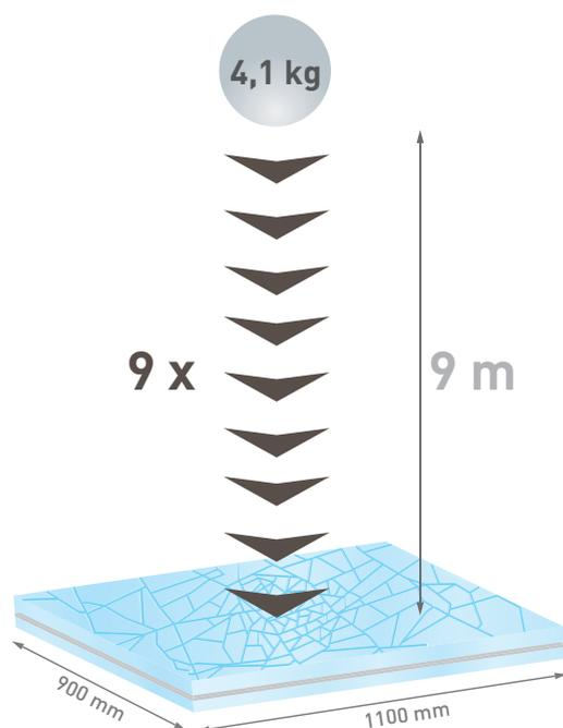
Ce vitrage retardateur à l'effraction résiste à la perforation d'une bille de 4,1 kg, lâchée 9 fois d'affilée de 9 m de haut.
